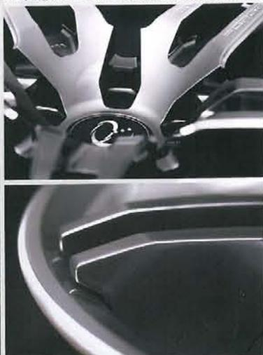
↑リムを乗り越えるようにデザインされたツインスポークの端は、リムから1mmのクリアランスで浮いている。精度の高さが伺える仕様
